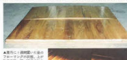
■意外に！ 通間埋め後のフローリングの状態。上が従来塗装、下が漆透性強化樹脂塗装。従来塗装のフローリングが強張り戻ってしまいます。漆透性強化樹脂塗装のフローリングは、ほとんど変化していないのがわかります。
